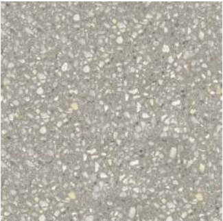
Шлифованный на белом мраморе на сером бетоне
