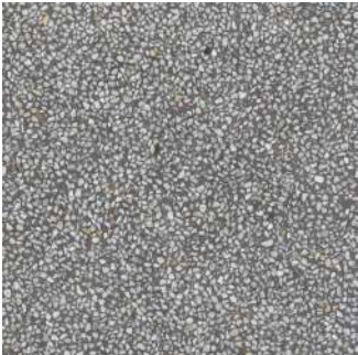
Шлифованный на мелком мраморе на сером бетоне
