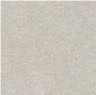
Шлифованный на мелком белом мраморе на белом бетоне
